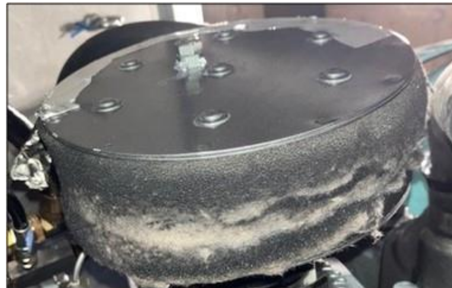
劣化したエアフィルタ
