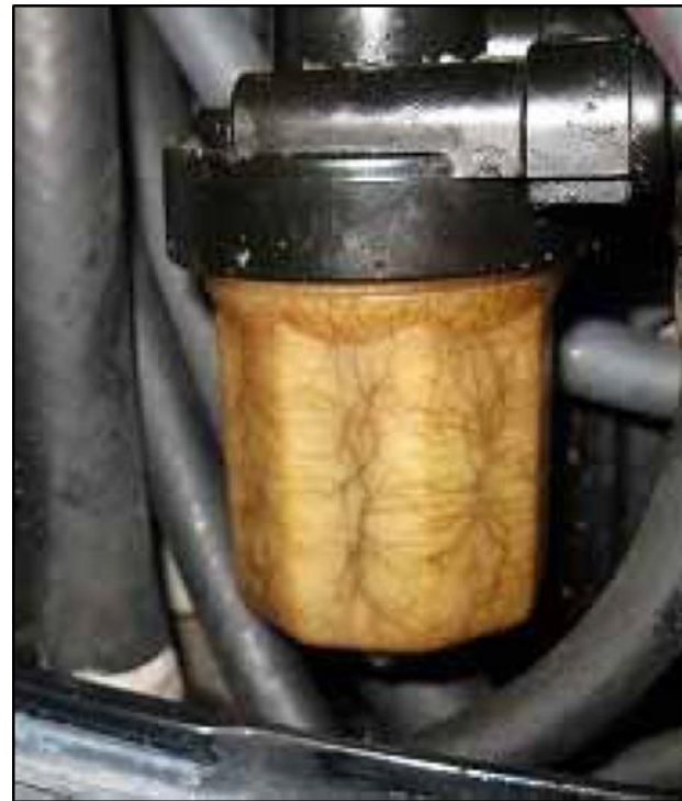
フィルタケースの劣化
