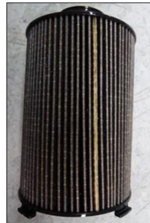
劣化したフィルタ
